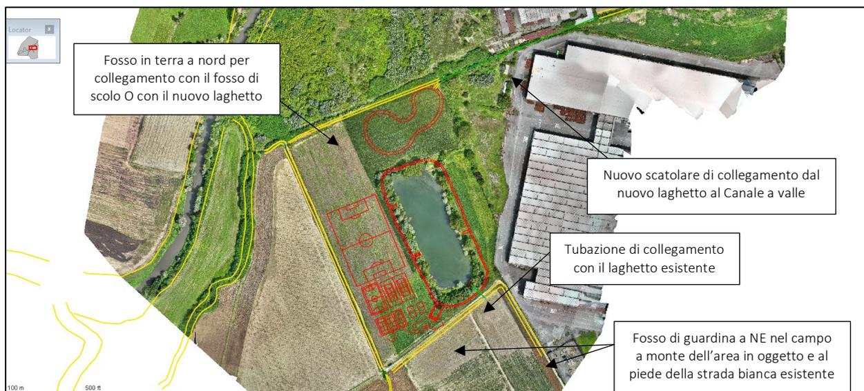
**Figura 53 - Geometria del modello idraulico allo stato di progetto su base Ortofoto con la sovrapposizione delle ipotesi di progetto relative alla realizzazione del centro sportivo.**
