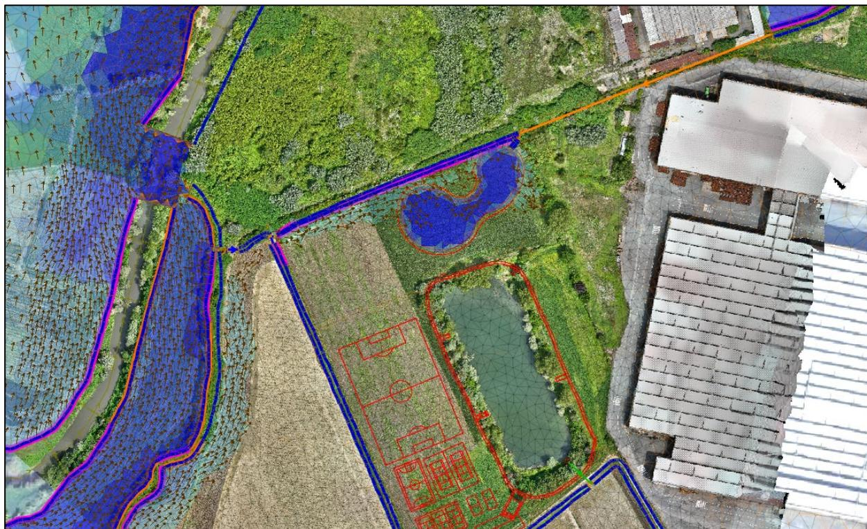
*Figura 59 – Planimetria delle aree di esondazione nel momento in cui il livello del Chisola alla confluenza con il Canale del molino raggiunge la quota dell’estradosso dello scatolare, rigurgitandolo.*
