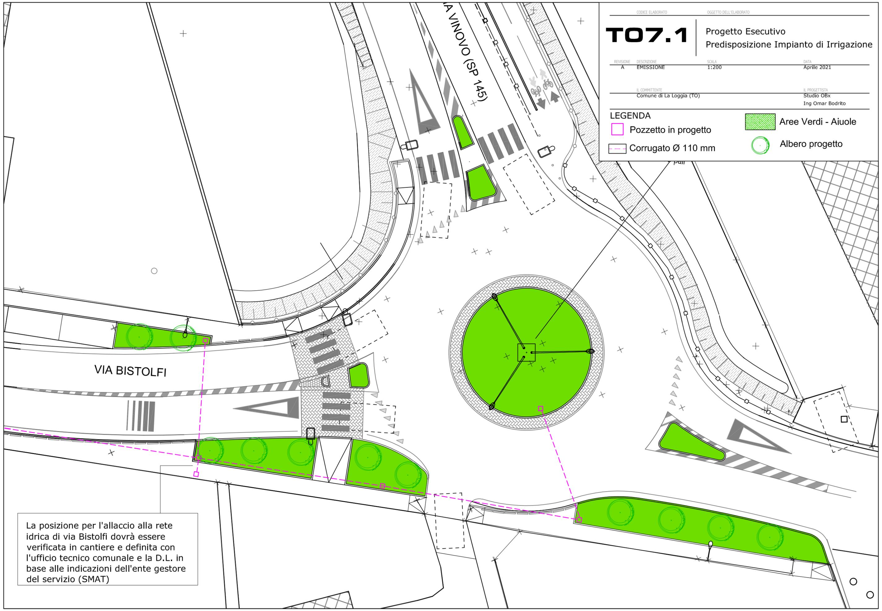
La posizione per l'allaccio alla rete idrica di via Bistolfi dovrà essere verificata in cantiere e definita con l'ufficio tecnico comunale e la D.L. in base alle indicazioni dell'ente gestore del servizio (SMAT)
